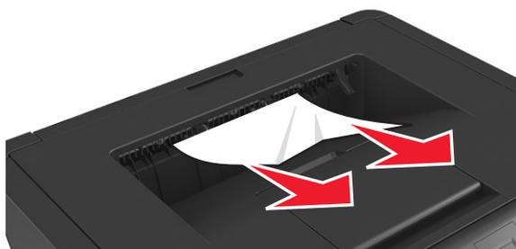
2 En el panel de control de la impresora, seleccione **Siguiente** > **OK** > **Elimine el atasco**, pulse **Aceptar** > **OK** para borrar el mensaje y seguir imprimiendo.
